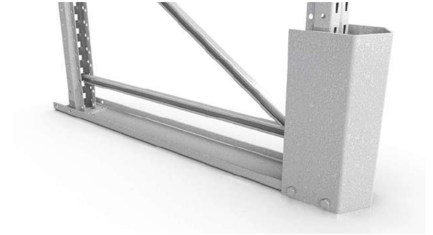
Lattiakisko U150, 1180 mm, maksimikuorma 6000 kg. Törmäyssuoja kiinnitetään lattiakiskoon.
