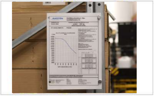
20 Kuormituskyltti kiinnitetään pylväselementtiin näkyvälle paikalle.
