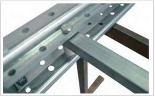
4 Vaakatuen vapaan pään kiinnitykseen lisätään holkki tukemaan liitosta.
