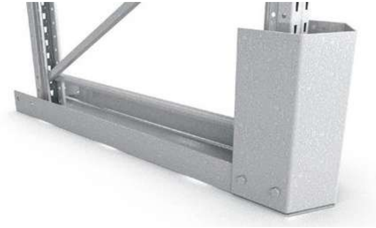
Lattiakisko UNP220, 1160 mm, maksimikuorma 8000 kg. Törmäyssuoja kiinnitetään lattiakiskoon.
