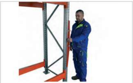
13 Pylvään sallittu poikkeama pystysuorasta on hyllystön korkeus jaettuna 350:llä.
