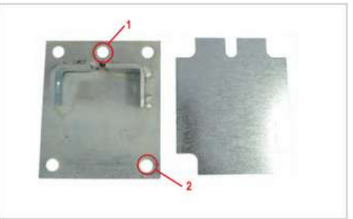
17 Järeämpi aluslevy kiinnitetään reiästä 1 ja tarvittaessa reiästä 2 kiila-ankkurilla M12x100 mm.
